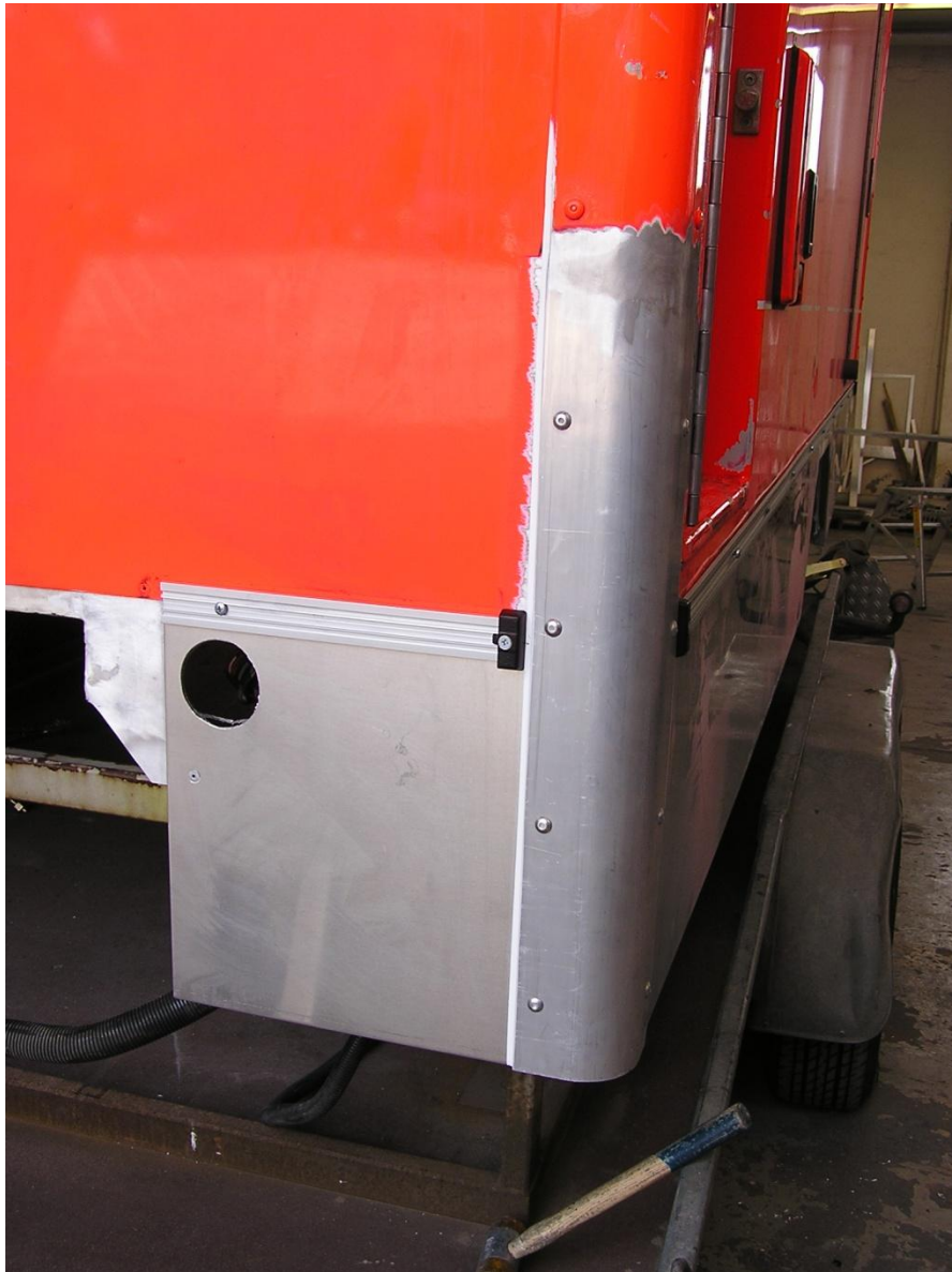
Instandgesetzte vordere Koffersäule.
