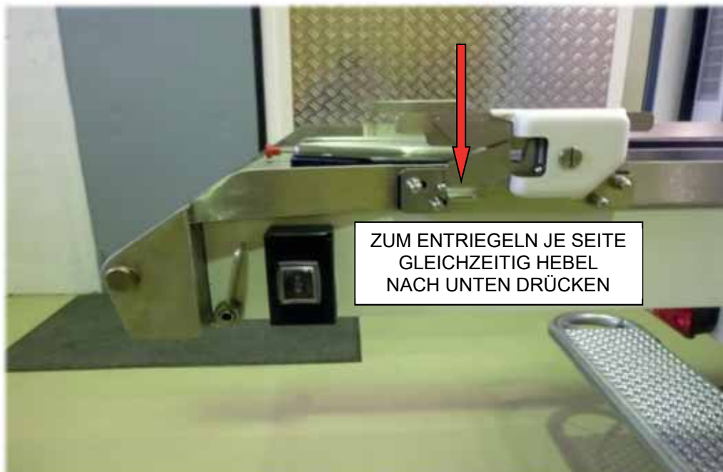
Bild 8 Entriegelung DIN-/Stollenwerk Krankentrage (1)
