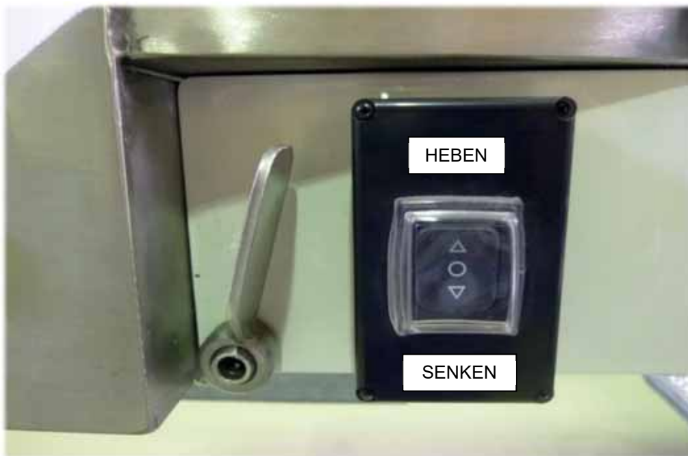
Bild 5 Heben/Senken der Oberbühne zum Be- und Entladen
