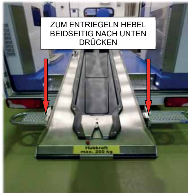
Bild 9 Entriegelung DIN-/Stollenwerk Krankentrage (2)
